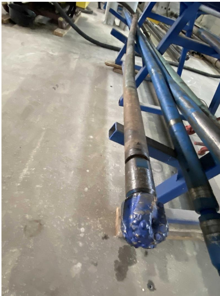
Рисунок 9 – ВЗД ДОТ - 49 с долотом типа PDC диаметром 68 мм
