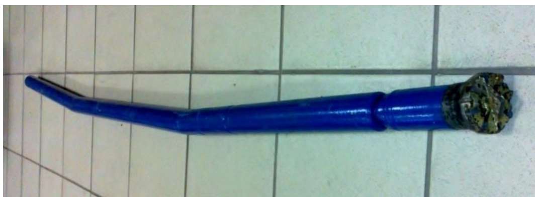
Рисунок 3.20 - КНБК перфорационного комплекса с двухсекционным винтовым двигателем 2Д-43.5/6.42.010, с кривыми переводниками с углами перекосов 5° и шпинделем ВНИИБТ с усиленным валом
