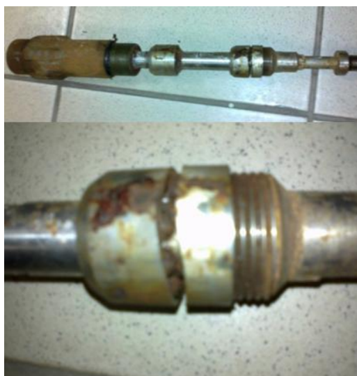
Рисунок 16 - Выход из строя шарового соединения вала шпинделя с ротором силовой секции
