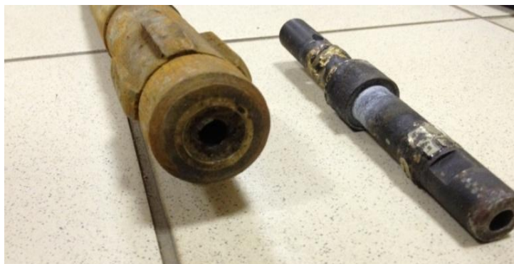
Рисунок 15 - Усталостный излом вала шпиндельной секции (слева), справа - заготовка нового вала
