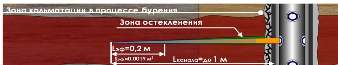
Рисунок 2 - Схема вскрытия пласта при кумулятивной перфорации
